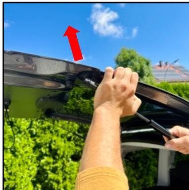
Vergewissere dich durch eine Zugprobe dass die Dämpfer korrekt verrastet sind.
