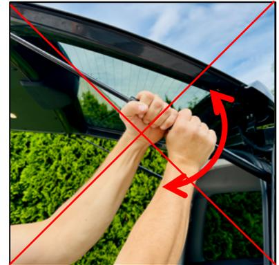
3.3 Den Dämpfer nun auf den Kugelbolzen aufdrücken. Um eine genaue Passung der Kugelpfanne zum Bolzen zu erlangen ist ggf. die Heckklappe etwas anzuheben oder abzusenken.
