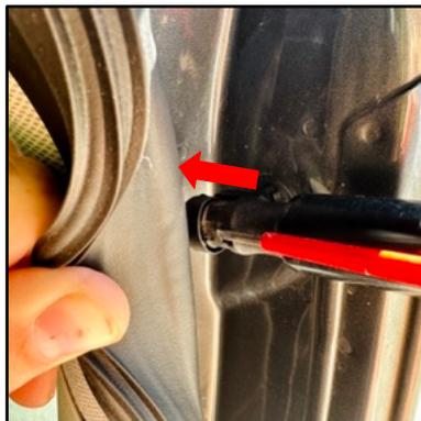
2.3 Die Dämpfer nun von den Kugelbolzen abziehen.
